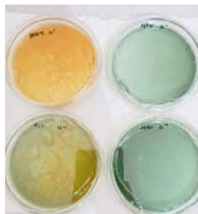
Before-After uji Vibrio: Air budidaya sebelum perlakuan (kiri) mengandung Vibrio tinggi. Setelah proses elektrolisis (kanan), konsentrasi Vibrio menurun drastis
