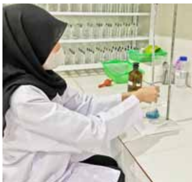
Pengecekan Calsium pada Air budidaya melalui metode titrasi (foto Muh Alwi)
