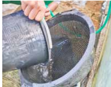
Sampai di unit penetasan langkah berikut saring untuk membuang sisik ikan, ranting,daun. Kotoran lebih kecil masih lolos saringan
