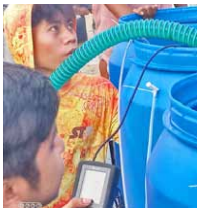
Pengecekan DO, pH & salinitas (cek kualitas air) sebelum distribusi ke growth out pond (foto Syahery_ tim STP Hatchery)
